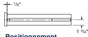
Positionnement, coulisses sur tiroir central
